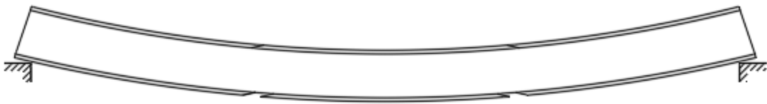
Рис. 3. Схема разрушения панели от разрыва нижней обшивки в соединении на "ус"
