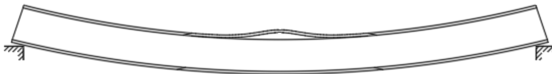
Рис. 5. Схема разрушения панели от потери устойчивости верхней сжатой обшивки
