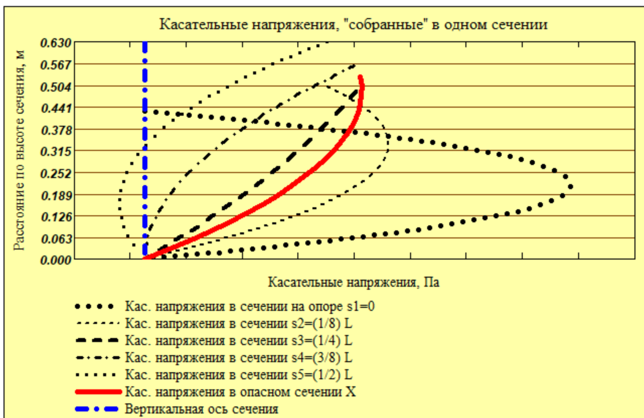
Рис. 12. Распределение касательных напряжений по высоте сечений на различных расстояниях s_1, s_2, s_3, s_4 и s_5 от опоры, условно "собранные" в одном сечении
