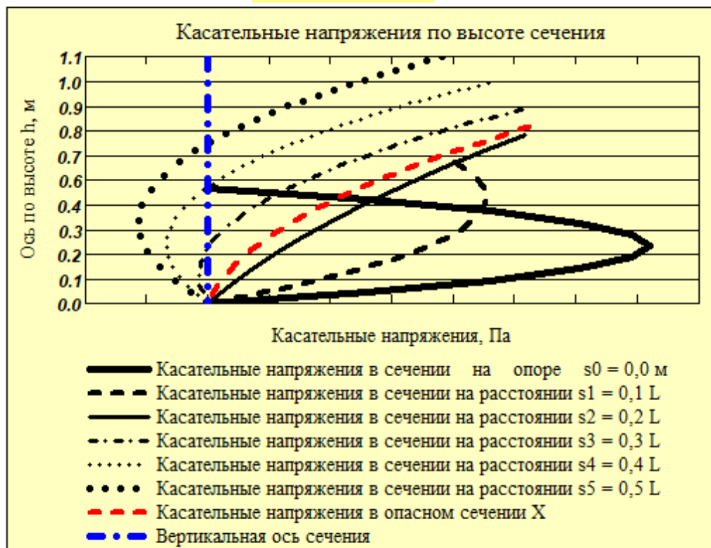
Рис. 10. Распределение касательных напряжений по высоте сечений на различных расстояниях s_0, s_1, s_2, s_3, s_4 и s_5 от опоры, условно "собранные" в одном сечении
