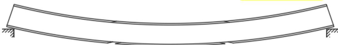
Рис. 4. Схема разрушения панели от разрыва нижней обшивки в соединении на "ус"
