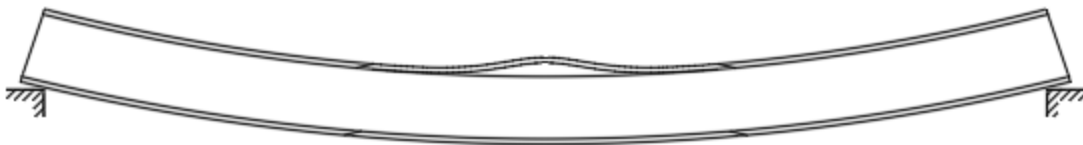
Рис. 4. Схема разрушения панели от потери устойчивости верхней сжатой обшивки
